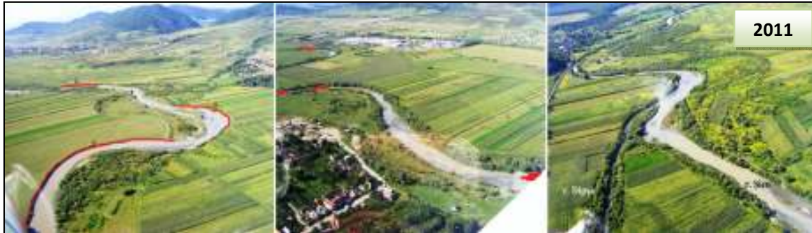
Fig. 36. Erosion of riverbanks, migrating scour Șieului (Podirei, Arcalia, Chiraleș), aerofoto-august.
